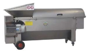
Despalilladora con motor realizada completamente en acero inoxidable, equipada con tolva de recepción con sinfín de entrada, eje despalillador con paletas forradas en goma, tambor de despalillado giratorio para contrarrestar el golpeo de las paletas y bomba de impulsión de pasta alimentada por sinfín. Totalmente abrible por la parte central para realizar una perfecta limpieza al final de la campaña
