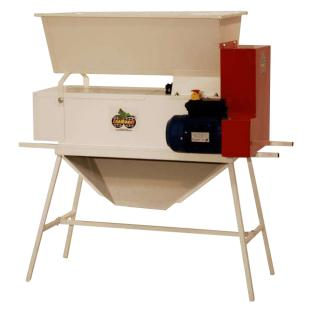
Despalilladoras equipadas con dos rodillos de aluminio de 220 mm. En todos los modelos la parrilla de despalillado es de acero inox., los soportes utilizados para fijar los rodillos permiten la regulación del grado de estrujado, y además dispone de un tensor que garantiza la integridad de los mismos y de los engranajes en el eventual paso de partes sólidas.
