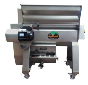
Despalilladoras estrujadoras completamente de acero inoxidable con parrilla de despalillado de tipo profesional con agujeros avellanados, las paletas del eje despalillador están recubiertas en goma para un trato más respetuoso de la uva, permite la posibilidad de realizar solamente el despalillado desconectando el grupo estrujador, los rodillos del grupo estrujador son de goma atóxica con perfil redondeado y regulables para poder obtener un perfecto estrujado.
