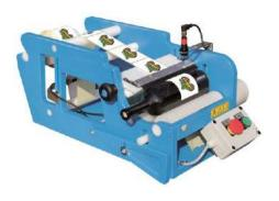
Etiquetadora fabricada en polietileno PE500, con rodillos en goma y tortillería en acero inox. Dotada de motor monofase, fotocélula y pulsador de Start para realizar el etiquetado. Nos permite la colocación de etiquetas adhesivas en cualquier envase de superficie lisa, de forma rápida y cómoda.
