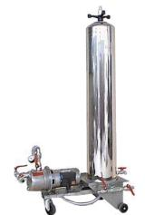
Los filtros de tierras están indicados para el desbaste del mosto recién prensado. Este proceso se realiza por medio de una tela que soporta harinas fósiles y / o fibras de celulosa.
