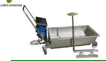
Equipos diseñados para el lavado interior de depósitos, construidos totalmente en acero inox. AISI 304 y dotados de tolva de recolección, bomba centrifuga inox., filtro de limpieza extraible, válvula de descarga total, instalación eléctrica CE con paro de emergencia, cuatro ruedas de transporte con freno de bloqueo y cabeza de lavado inox.
