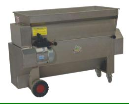
Despalilladora con motor realizada completamente en acero inoxidable, equipada con tolva de recepción con sinfín de entrada, eje despalillador con paletas forradas en goma, tambor de despalillado giratorio para contrarrestar el golpeo de las paletas y bomba de impulsión de pasta alimentada por sinfín. Totalmente abrible por la parte central para realizar una perfecta limpieza al final de la campaña
