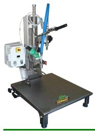
Máquina ideal para empresas con pequeños volúmenes de producción anual, fabricada completamente en acero inoxidable, con 4 pies ajustables, no necesita ningún suministro neumático, existe la posibilidad de adaptar una bomba externa compatible.
