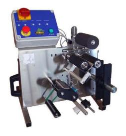
Etiquetadora semiautomática de banco para etiquetas adhesivas. Con estructura totalmente en acero inox. y equipada de un rollo de arrastre del papel siliconado de tipo granado con desbloqueo rápido. Dotada de motor monofase, permite el pegado de etiquetas adhesivas con unas medidas máximas de 280 mm. de largo y 140 mm. de alto en envases cilíndricos con diámetros comprendidos entre 45 y 120 mm. (Opcionalmente puede adaptarse a otros tamaños de etiquetas y a diferentes diseños de botellas.)
