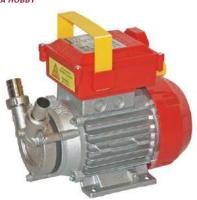
Electrobomba autoaspirante de doble sentido con rotor rígido de geometría radial. Este tipo de turbina le otorga una extraordinaria capacidad autocebante, incluso en presencia de una discontinuidad del líquido que se tiene que trasvasar. Diseñadas para el trasvase de líquidos cuya temperatura no exceda de los 95°C. La parte hidráulica está realizada completamente con una aleación inoxidable especial.
