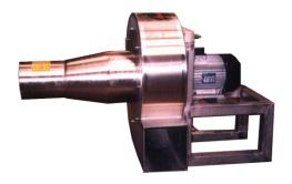
Extractor de raspón construido en acero inoxidable equipado con motor eléctrico.
