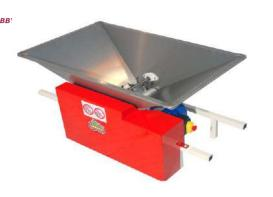
Estrujadoras para manzana con rodillos regulables y eje de cuchillas en acero inoxidable. Los soportes utilizados para fijar los rodillos permiten la regulación del grado de estrujado, y además dispone de un tensor que garantiza la integridad de los mismos y de los engranajes en el eventual paso de partes sólidas.
