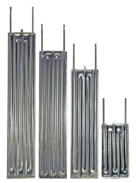
Placas de refrigeración construidas en acero inoxidable AISI 304 predispuestas para conexión directa a manguera  $\emptyset$  20 interior o para racor roscado de  $\frac{1}{2}$ ".
