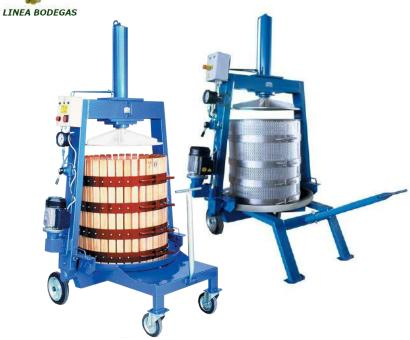
Prensas con pistón hidráulico de doble efecto monofase, manómetro de control de presión y ruedas de transporte.
