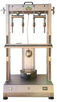
Llenadora de sobremesa fabricada completamente de acero inoxidable, con componentes de alta calidad preparados para un uso intensivo. La máquina está equipada con un sistema eléctrico que produce vacío en el interior de la botella, a fin de crear una succión delicada del líquido a llenar sin el uso de bombas y evitando problemas de oxidación.
