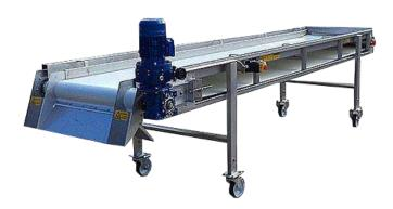
Construida completamente en acero inoxidable AISI 304, con cinta de arrastre apta para el contacto con alimentos, estructura robusta de acero inoxidable, dos canales de selección, patas telescópicas, ruedas con freno de bloqueo, variador de velocidad estándar y panel con parada de emergencia. Tolva para descarga de producto (opcional).
