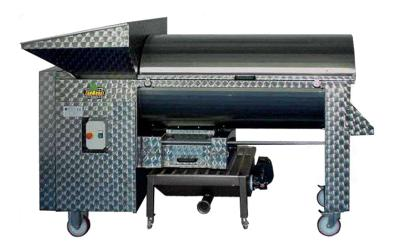
Despalilladoras centrifugas con tambor giratorio construidas totalmente en acero inoxidable. Todos los modelos están dotados de un variador de velocidad que permite regular el número de giros del sinfín de alimentación, el eje despalillador y el tambor, con el fin de optimizar el proceso y la calidad del producto final.
