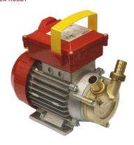
Electrobomba autoaspirante de doble sentido de anillo líquido, lateral, con rotor de geometría radial. Este tipo tan particular de descubrimiento le otorga una extraordinaria capacidad autocebante, incluso en presencia de alguna discontinuidad del líquido que se tiene que trasvasar.
