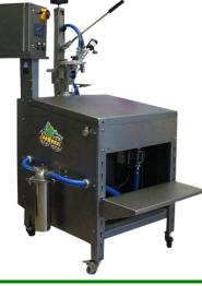
Llenadora de envases Bag in box semiautomática de gran versatilidad y fácil uso. Realiza automáticamente el ciclo completo de llenado; vacío, llenado, detención e inyección de nitrógeno. El panel electrónico permite el control y la gestión de todas las fases durante el llenado, garantizando una repetición de los volúmenes con un error de ± 5cl.
