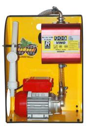
Los dispensadores están compuestos de una estructura metálica lacada, una electrobomba inoxidable, cuentalitros de doble lectura con posibilidad de puesta a 0 del contador parcial, pistola de plástico alimentaria, tubo cristal reforzado apto para productos alimentarios, filtro de aspiración y abrazaderas.
