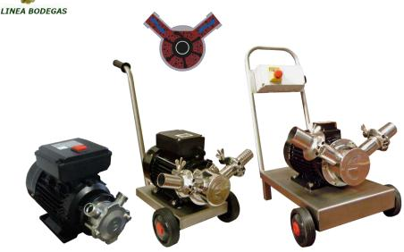
Electrobombas con cuerpo de acero inoxidable y turbina en goma alimentaria aplicada directamente al motor eléctrico. Están indicadas para el trasiego de líquidos, incluso en presencia de partes sólidas en suspensión, como vino, aceite, leche, miel, zumo de fruta, etc.
