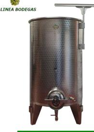
Depósitos siemprellenos de fondo cónico, construidos totalmente en acero inoxidable AISI 304, ideales para la conservación del vino. El sistema siemprelleno nos garantiza un perfecto almacenamiento en este tipo de depósitos gracias a la tapa neumática y al total sellado que nos proporciona la cámara de aire, evitando oxidaciones. Recomendados para el almacenamiento de diferentes productos alimentarios como vino, sidra, aceite, cerveza, etc.
