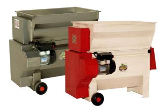
Despalilladoras a motor equipadas con una tolva de recepción con sinfín de entrada, eje y parrilla de despalillado para la expulsión del raspón y una bomba centrifuga alimentada por sinfín., el estrujado de la uva se obtiene a través de la acción combinada del eje despalillador y las paletas de la bomba. En todos los modelos la parrilla de despalillado y la bomba centrifuga están realizadas en acero inox.
