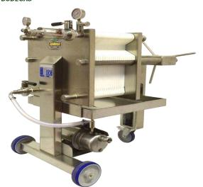
Filtros prensa construidos completamente en acero inoxidable AISI 304, se presentan sobre una estructura portante con ruedas, y están dotados de electrobomba inox, bandeja de recolección inox, válvulas de regulación en entrada y salida, grifos de purgado del aire y extracción de muestra del producto durante el filtrado, tubo de vidrio para observación en salida y manómetros de control de presión.
