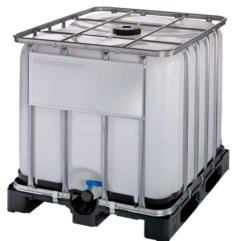
Depósito de plástico apto para el uso alimentario, con jaula de protección metálica y sobre palet de plástico, incorpora en la parte superior una boca circular de  $\varnothing$  250 mm. y una válvula de descarga total en la inferior.
