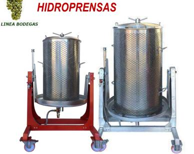
Prensas dotadas de una membrana interior que por la acción del agua realiza el prensado de uvas despalilladas, uvas estrujadas, uvas fermentadas, manzana o cualquier otro tipo de fruta.
