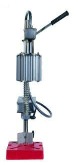
Capsuladora monofase dotada de regulador de temperatura, instalada sobre un robusto pedestal con palanca de movimiento.
